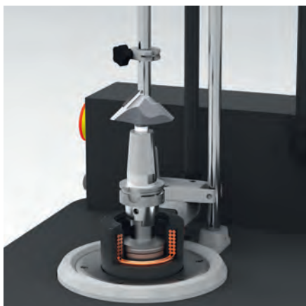
Bild1: Einsetzen Werkzeugträger Image1: Inserting tool adaptors
