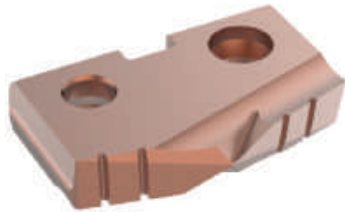
150°结构钢 适用于厚度超过7/16"的材料，并可减少退刀毛刺
