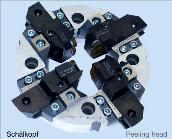
Wendeschneidplatten-schlitten Insert slide
