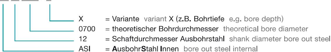
Die Ausbohrstähle sind auf die Geometrie des jeweiligen Kurvenblockes abgestimmt.
