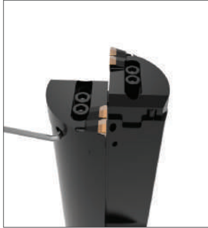
第2步： 抵住调节销拧紧调节螺钉，为一个刀夹设置成孔直径。
